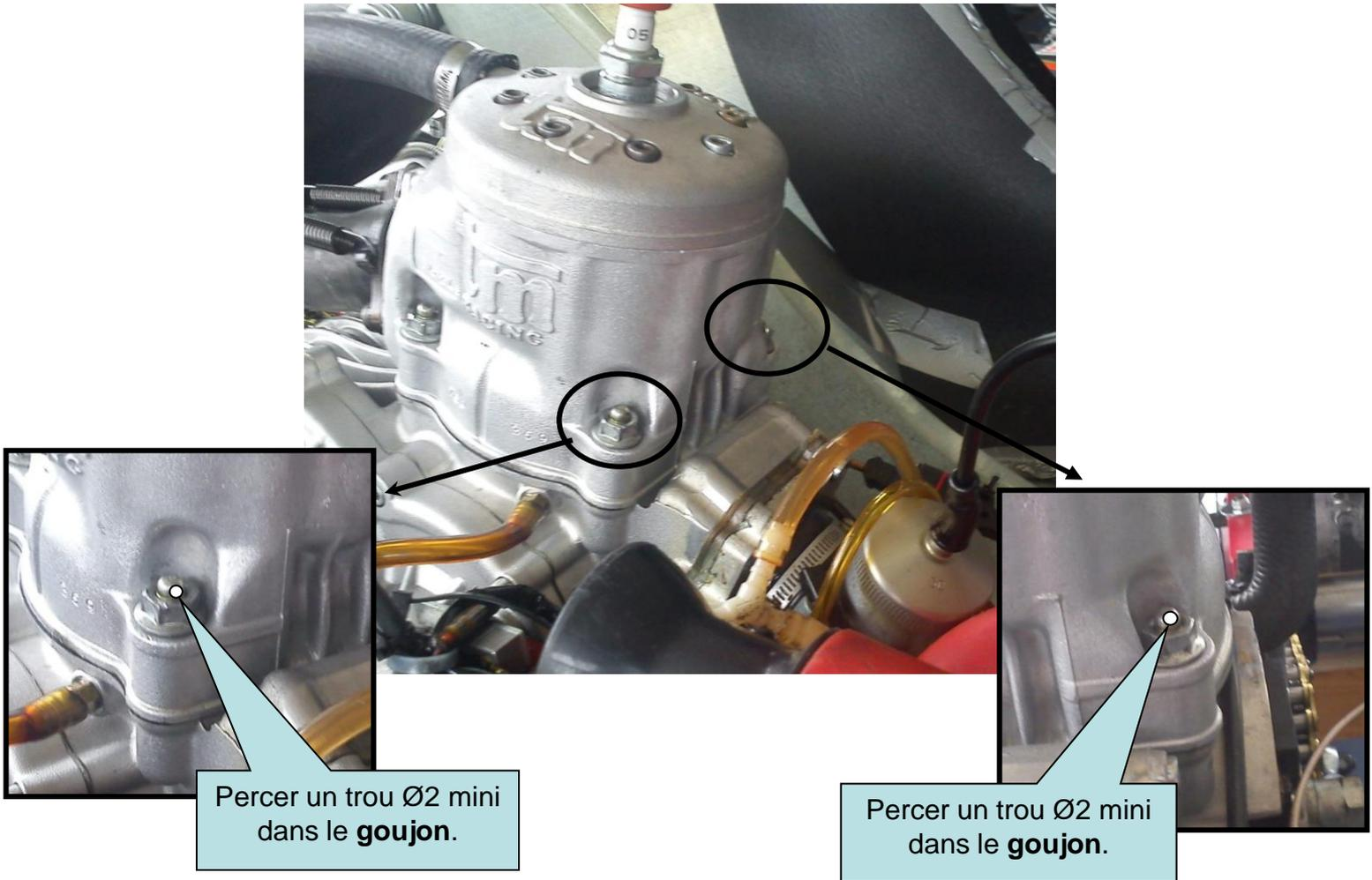
Percer les trous de façon à ce que le câble de plombage puisse passer facilement.
